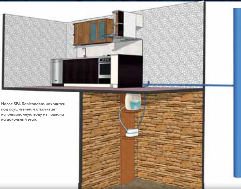
Установленный в подвале осушитель
