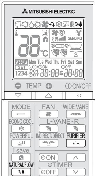
Нажмите кнопку в режиме COOL (ОХЛАЖДЕНИЕ) или FAN (ВЕНТИЛЯТОР) стр. 6, чтобы запустить режим NATURAL FLOW (ЕСТЕСТВЕННЫЙ ПОТОК).
