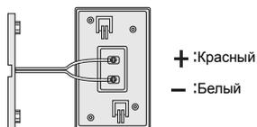
4) Кабель комнатного термометра должен быть установлен отдельно на видном месте.
