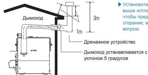
▶ Установите воздуховод на 3м выше котла и "Т" блок в конце, чтобы предотвратить неполное сгорание, вызванное встречным ветром.
