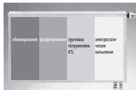
Подготовка поверхности радиатора
