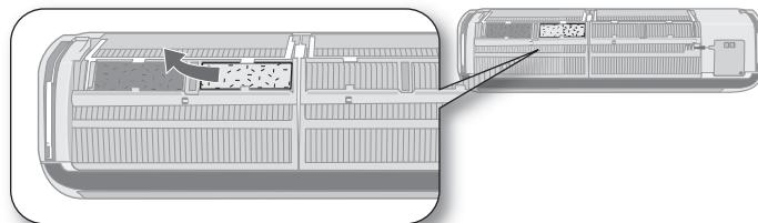
ДНК-фильтр допускается устанавливать в одно из четырех гнезд, расположенных под воздушным фильтром.
