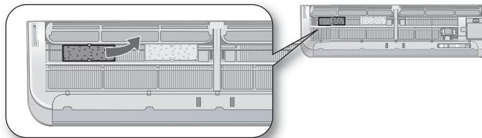
Фильтр-дезодоратор допускается устанавливать в одно из гнезд, расположенных под воздушным фильтром.
