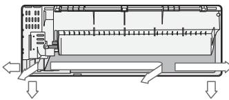
1. Выберите место для выполнения отверстия, сквозь которое пропускаются трубы и дренажный шланг, как показано на рисунке, и просверлите отверстие внутренним диаметром 65мм с небольшим уклоном вниз.
