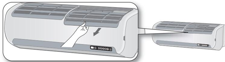
2. Проведите чистку воздушного фильтра пылесосом или мягкой щеткой. Если загрязнение фильтра значительное, промойте его проточной водой и просушите на воздухе.
