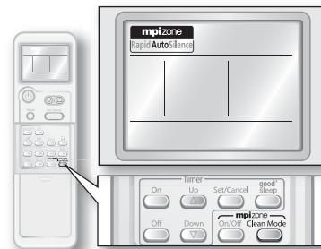
**Auto(Автом.)** : регулировка скорости вращения вентилятора происходит автоматически.
