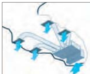
Установка в запотолочном пространстве
