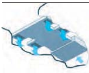
Установка за подвесным потолком
