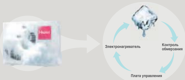
Нагреватель картера компрессора предотвращает холодный пуск.
