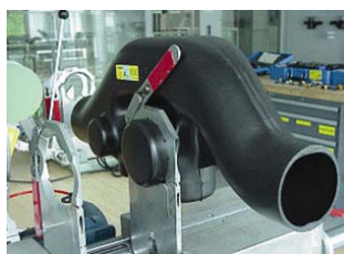
1. Зафиксируйте фитинг в сварочной машине
