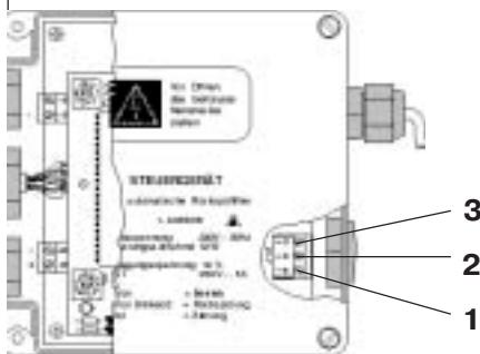
У фильтра, который первым будет проводить промывку, с помощью выключателя **S1** устанавливается нужный интервал между промывками. Выключатель **S1** у остальных фильтров устанавливается на **C**.
