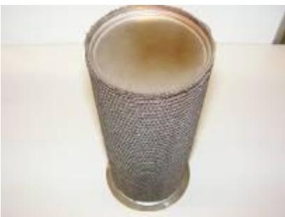
Сетка из нержавеющей стали устанавливается в целях улучшения рассеивания газовоздушной смеси и, как следствие, уменьшения высоты пламени
