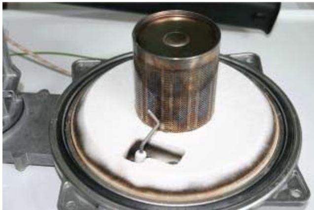
Горелка - это диффузор, функцией которого является распространение газовоздушной смеси на максимально широкой поверхности.
