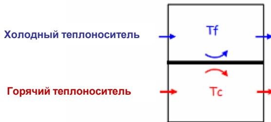
В случае теплообменника котла выделяют два теплоносителя:
