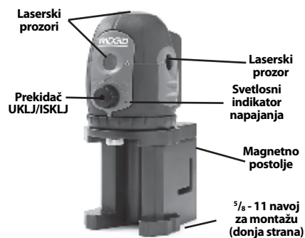
Slika 2 - Delovi lasera
