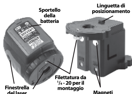
Figura 3 - Componenti della livella laser
