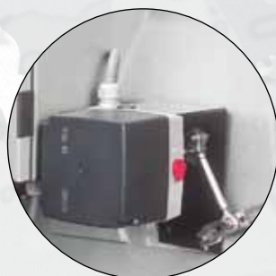
Электрический сервопривод для регулировки воздуха
