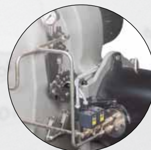
Клапанный узел и кулачок изменяемого профиля
