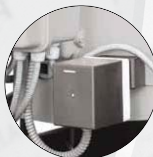
Электрический сервопривод для регулировки воздуха
