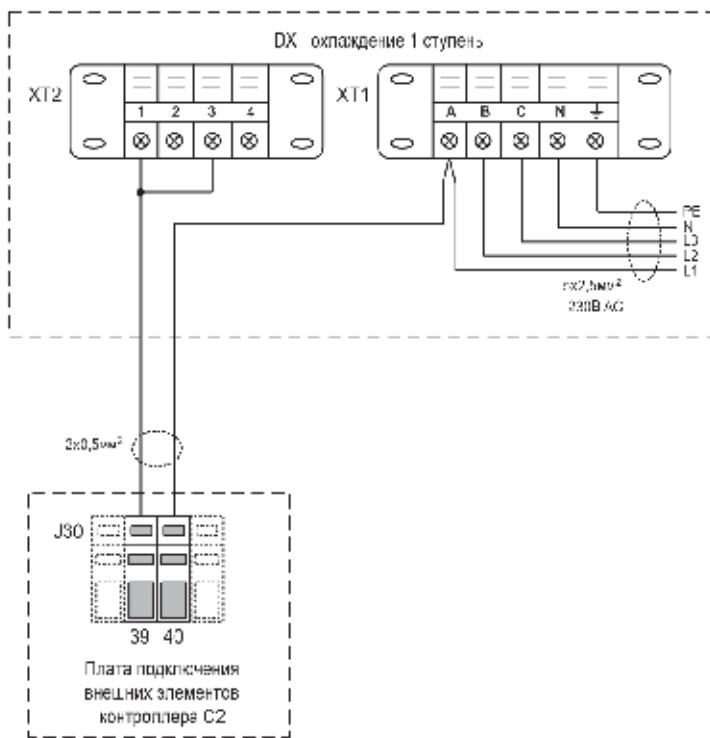
Подключение «MOU» к вентиляционным установкам с С3 контроллером, когда плата подключения внешних элементов C3-P1.
