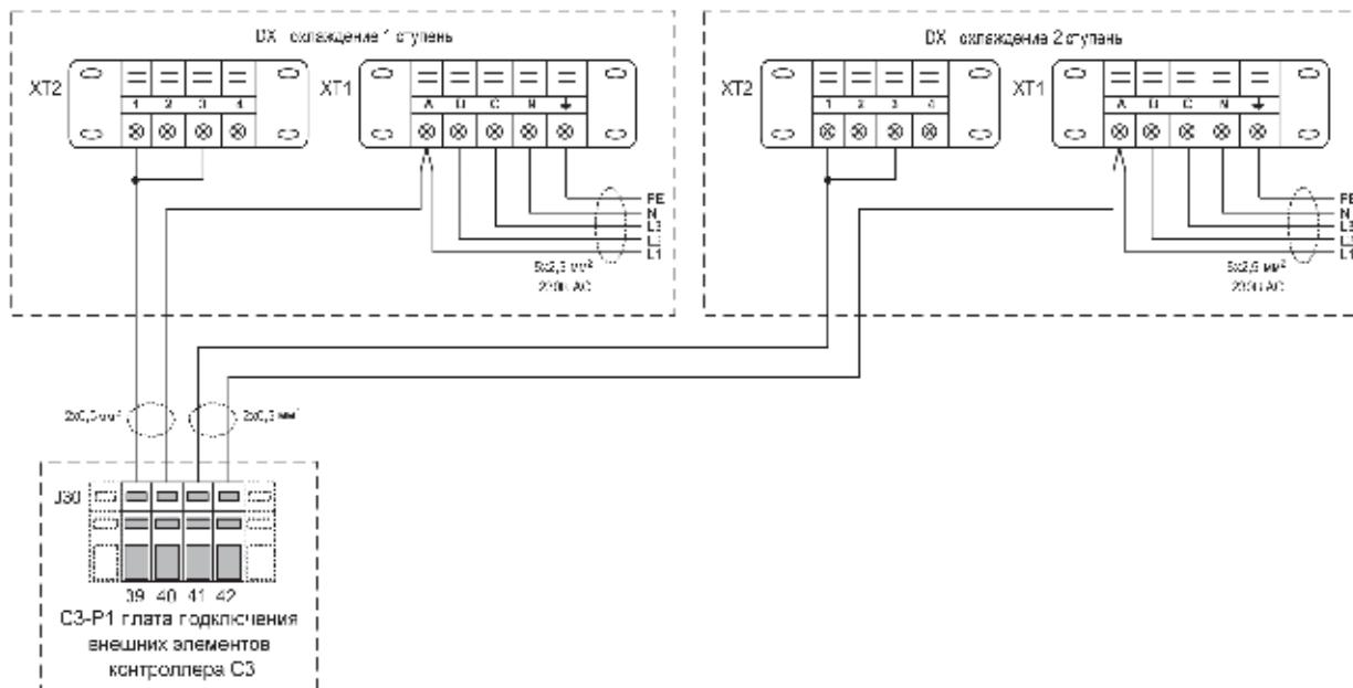
Подключение «MOU» к вентиляционным установкам с С3 контроллером, когда плата подключения внешних элементов Р3.
