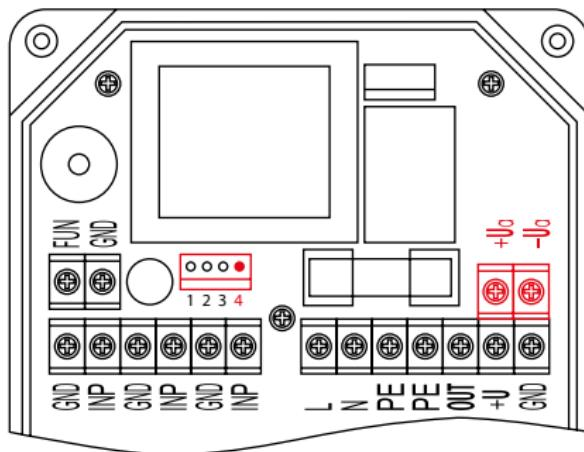
Подключение системы GIDROLOCK GSM
