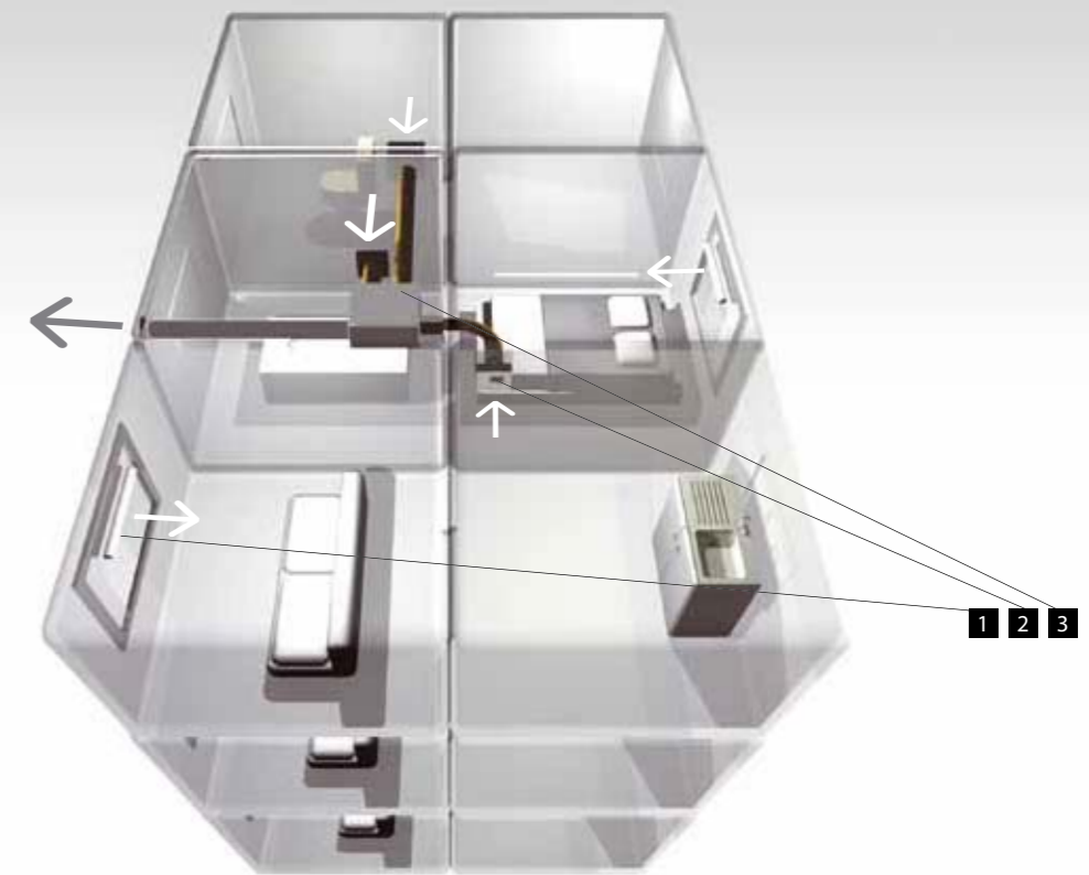
1. Приточные устройства. 2. Вытяжные устройства. 3. Вентилятор
