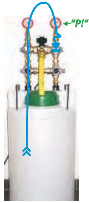
Rücklauf blockieren, Druck ablesen!
