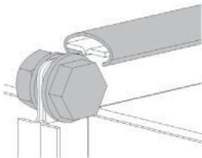
К воздуховодам вентилятор монтируется болтами и С-профилем.
