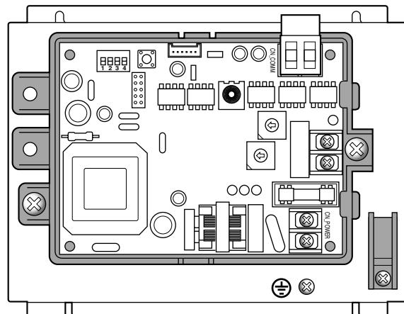
4. Подсоедините провод RS485 с A на задней панели AC Smart и BUS\_A на expansion kit, потом подсоедините его с B на задней панели и с BUS\_B.
