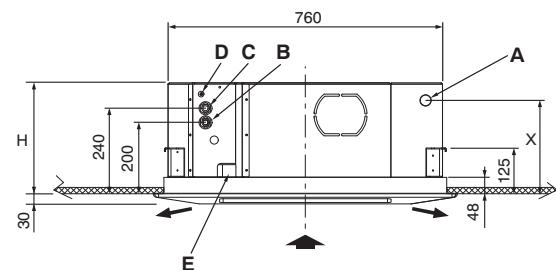
A Отверстие для конденсата: Наружный диаметр 32 мм
