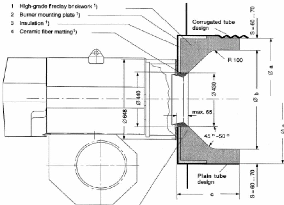
Огнеупорный материал для обмуровки должен иметь содержание  $\text{Al}_2\text{O}_3$ , по меньшей мере, 60% и термостойкость, по меньшей мере, 15.
