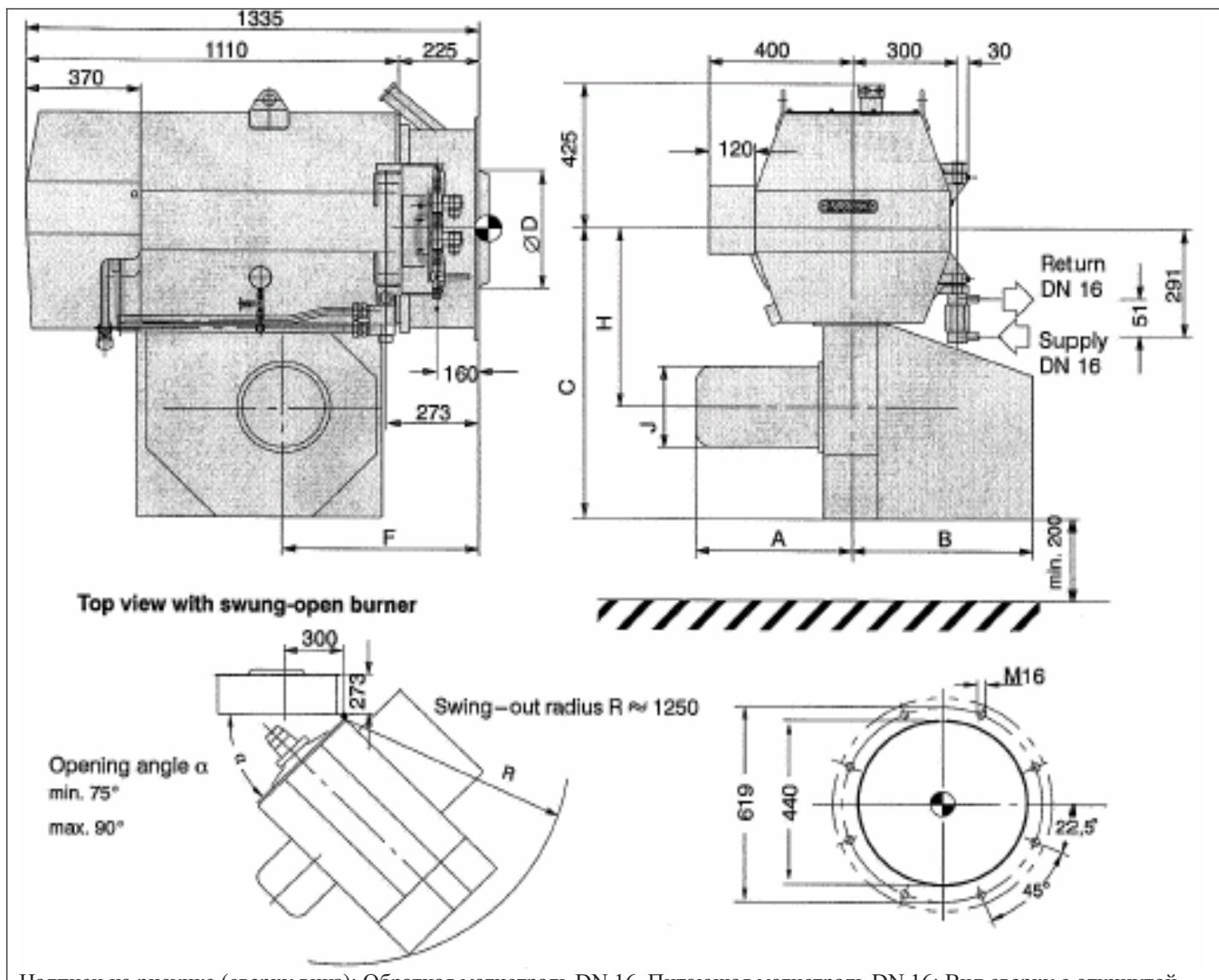
Надписи на рисунке (сверху вниз): Обратная магистраль DN 16; Питающая магистраль DN 16; Вид сверху с откинутой горелкой; Радиус откидывания  $R \approx 1250$ ; Угол открывания  $\alpha$ ; мин.  $75^\circ$ ; макс.  $90^\circ$
