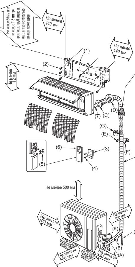
Обязательно используйте втулку для стенного отверстия (C) в целях предотвращения контакта соединительного провода (A) внутреннего/наружного прибора с металлическими деталями стенного перекрытия, а также для предотвращения повреждения проводов крысами, если стена полая.
