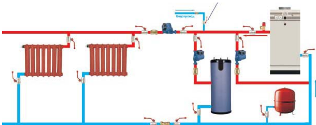
Рисунок 7. Схема подключения котла с принудительной циркуляцией теплоносителя.
