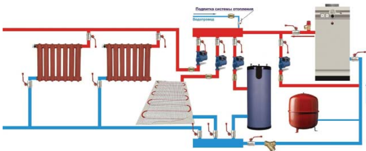
Рисунок 6. Схема подключения котла с общим коллектором.
