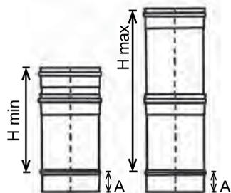
**Телескопический элемент 250-350 мм**
