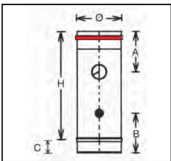
**Элемент дымохода для подключения газоанализатора и приборов измерения температуры**
