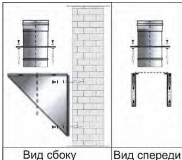
Рисунок 7а. Установка пары креплений с промежуточной пластиной
