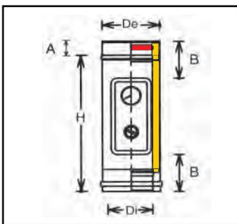
**Элемент дымохода с панелью контроля отходящих газов**
