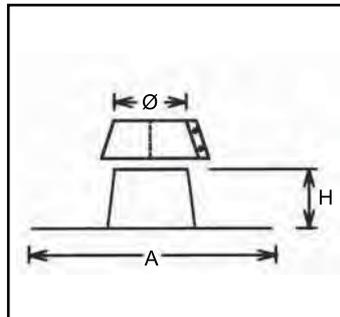
**Кровельный элемент с углом наклона 0°-5° с фартуком (основа из нержавеющей стали)**
