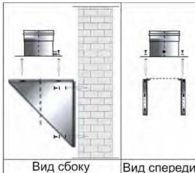
Рисунок 7б. Установка пары креплений с основой дымохода
