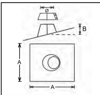
**Кровельный элемент с углом наклона 5°- 30° (свинцовая основа) с фартуком**
