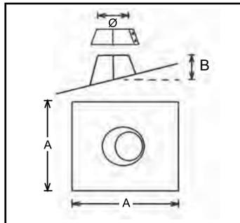
**Кровельный элемент с углом наклона 30°- 45° (свинцовая основа) с фартуком**
