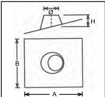
**Кровельный элемент с углом наклона 30°-45° (основа из нержавеющей стали)**
