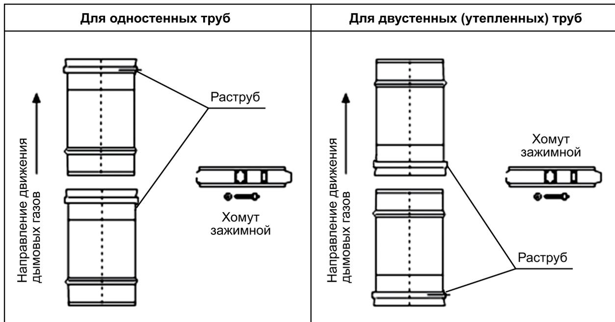
Перед началом монтажа необходимо осмотреть соединяемые трубы и фасонные части. На поверхности соединяемых труб и фасонных частей не должно быть вмятин, трещин, прорывов. Соединяемые поверхности должны быть чистыми.
