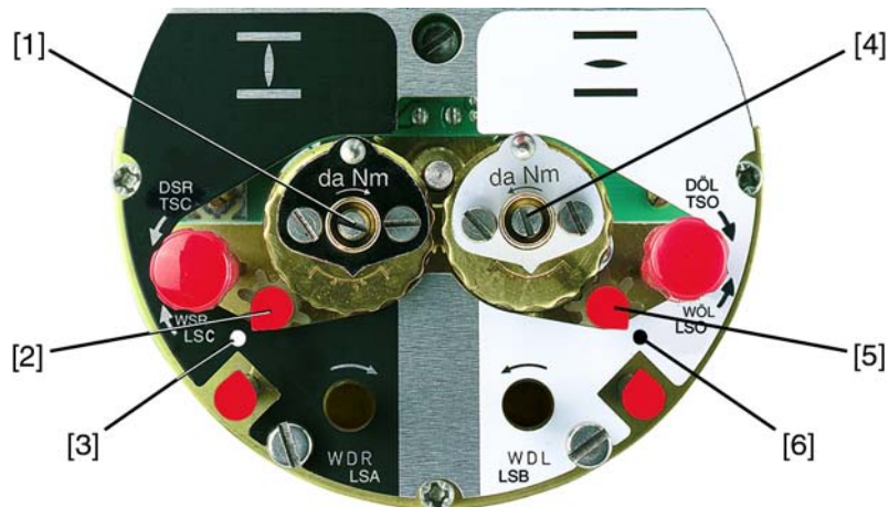
рис. 58: Регулировочные элементы концевого выключателя
