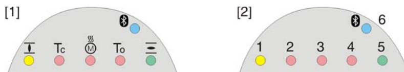
рис. 54: Расположение ламп и описание ламповой индикации
