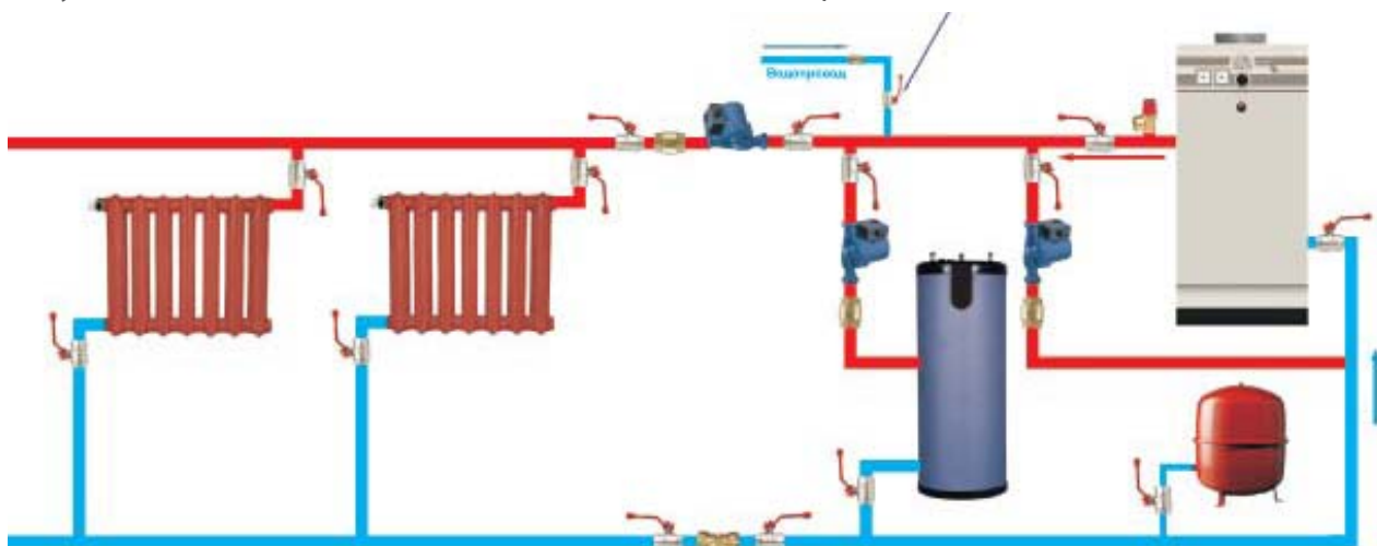
Рисунок 7. Схема подключения котла с принудительной циркуляцией теплоносителя.
