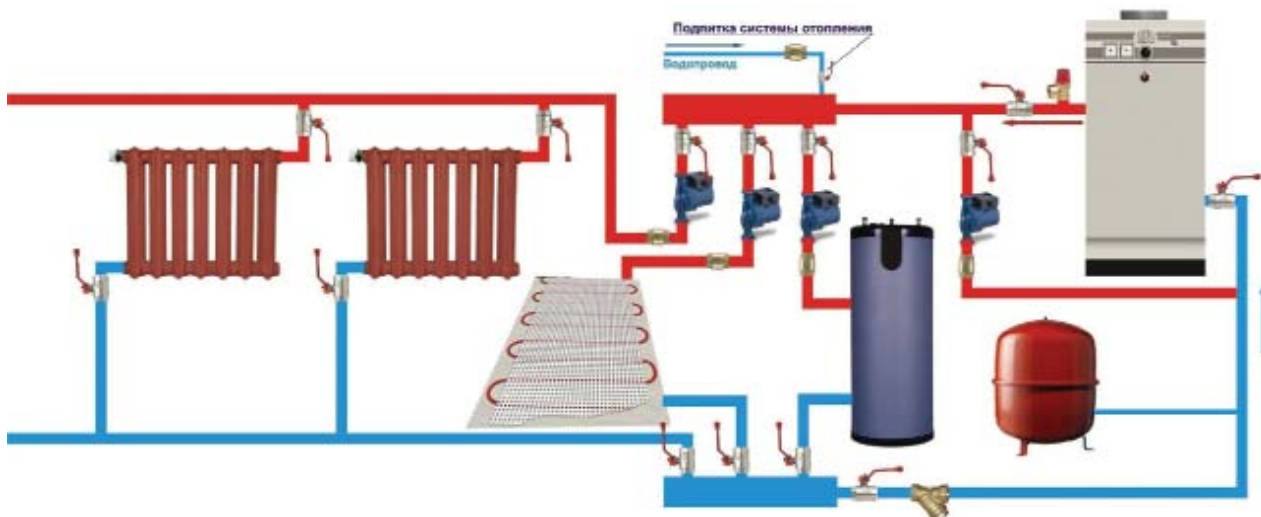
Рисунок 6. Схема подключения котла с общим коллектором.
