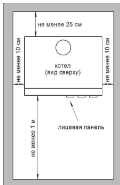
Рис. 5 – Схема установки котла
