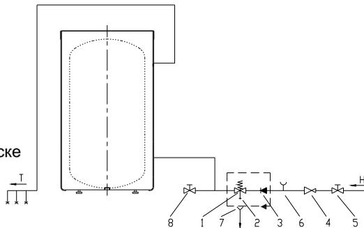
Котёл горячей воды можете подключить к водопроводной сети в доме без редукционного клапана тогда, когда давление в сети меньше 0,5 МПа.
