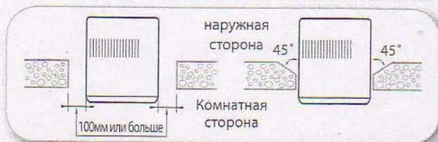
Если толщина стены в более 150мм, сократите заднюю часть стены в 45°.
