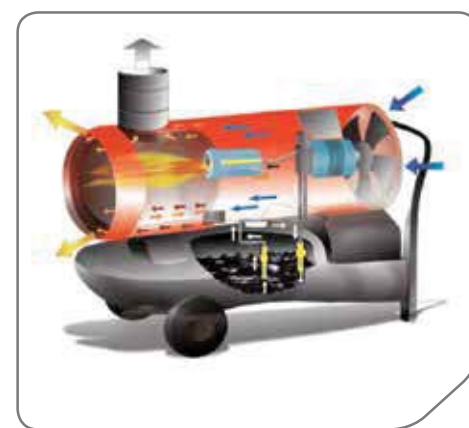
Принципиальная схема работы нагревателя серии EC
