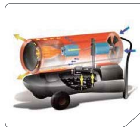
Принципиальная схема работы нагревателя серии GE
