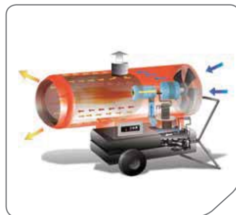
Принципиальная схема работы нагревателя серии PHOEN
