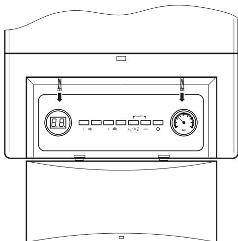
Для закрытия крышки оба винта должны быть полностью ввернуты!
