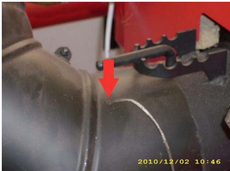
Рисунок 6 Установка зонда
