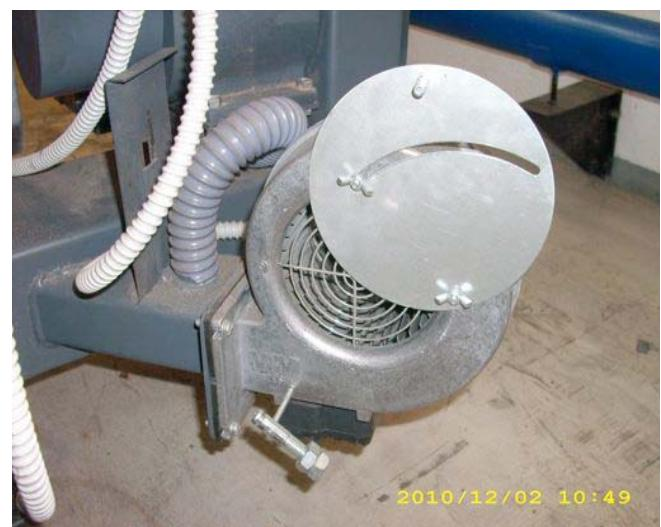
Рисунок 8. Положение макс. открытого клапана вент.
