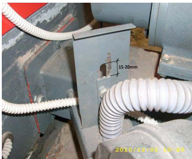
Рисунок 7. Положение клапана вентилятора
