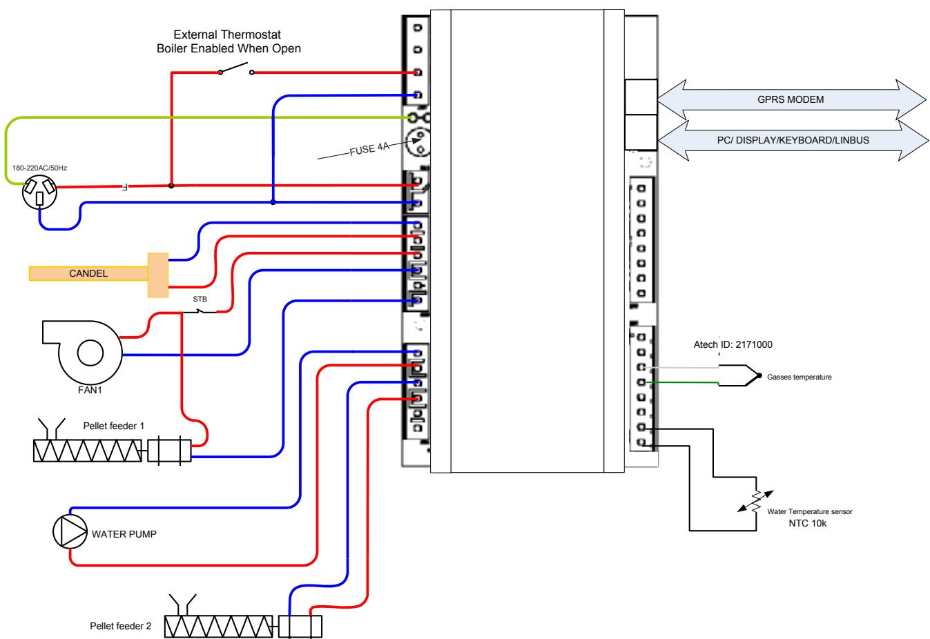
*Рисунок 4. Схема подключения автоматики*
