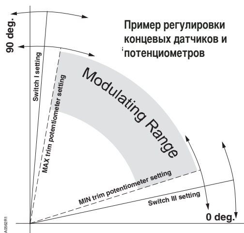
Рис. 13. Установка кулачков и подстроечных потенциометров.
