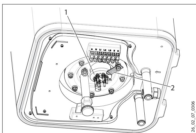
1 Керамический нагревательный элемент в эмалированной защитной трубе
