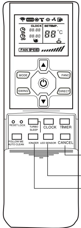
Данная кнопка используется для активации максимальной мощности (функция работает только в течение первых 10 минут, далее кондиционер переходит в обычный режим).
