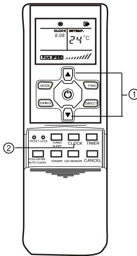
Перед первым запуском кондиционера установите показания часов пульта ДУ. Часовой дисплей на пульте ДУ показывает время и в том случае, если кондиционер выключен.
