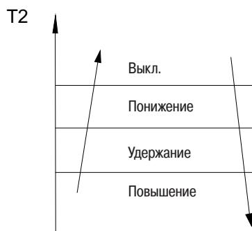
При увеличении температуры змеевика испарителя выше установленного значения, компрессор выключается.
