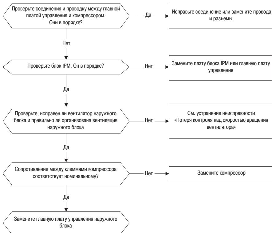
**Проверка цепей блока электропитания (IPM)**
