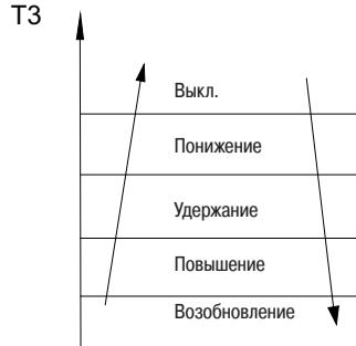
При увеличении температуры конденсатора выше установленного значения, компрессор выключается.
