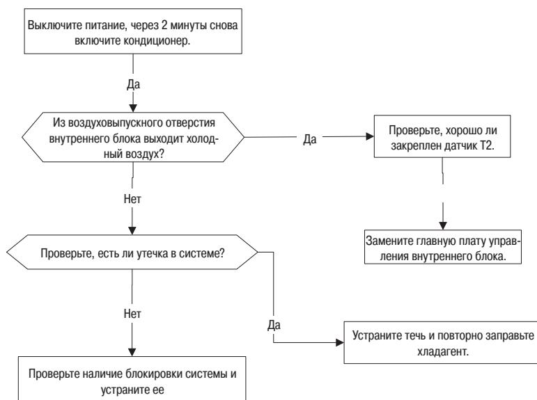
**Диагностика и устранение неисправностей, обусловленных обрывом или коротким замыканием в цепи датчика температуры (E5)**
