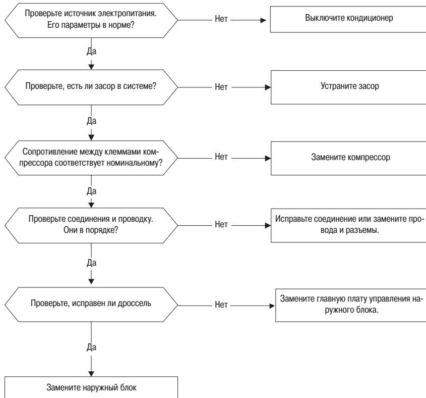
**Диагностика и устранение неисправностей блока электропитания (IPM) и неисправностей, обусловленных срабатыванием защиты от перегрузки по току IGBT (P0)**
