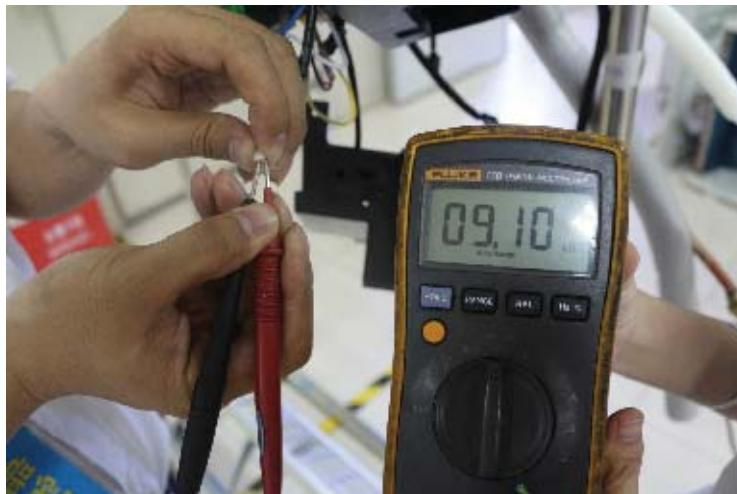
**Диагностика и устранение неисправностей, приводящих к срабатыванию токовой защиты (F0)**
