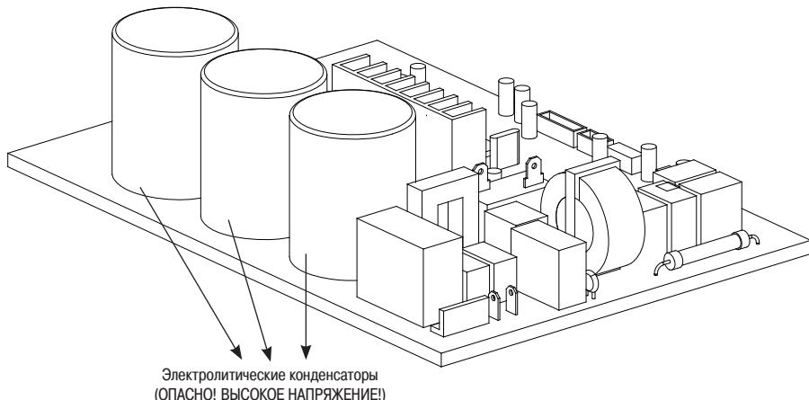
Для других моделей: присоедините разрядное сопротивление (прибл. 1000 Ом, 40 Вт) или вилку паяльника к клеммам «+» и «-» электролитического конденсатора с обратной стороны главной платы управления наружного блока.
