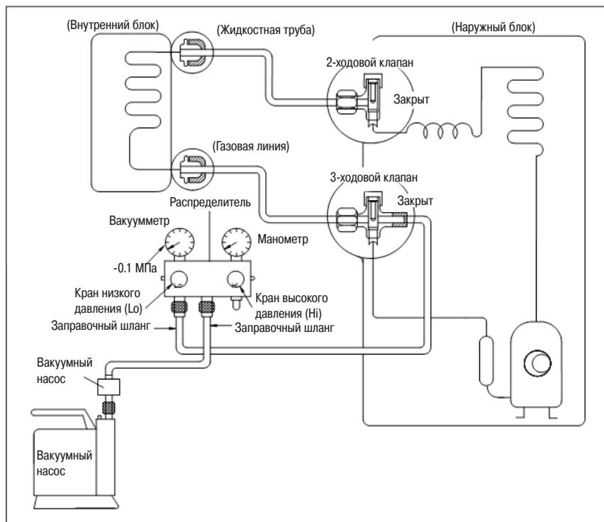
1. Полностью затяните накидные гайки на наружном и внутреннем блоках и убедитесь, что 2-ходовой и 3-ходовой клапаны находятся в закрытом положении.
