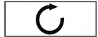
Electrobombas con sentido de rotación horario visto desde la boca de impulsión
