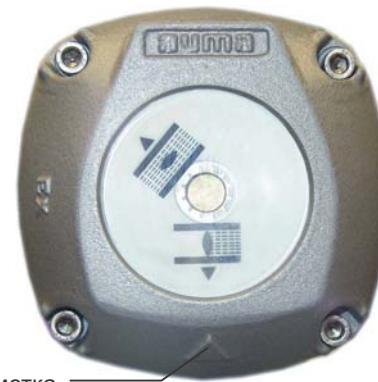
Индикаторный диск вращается примерно от 180 до 230 на полный ход от ОТКРЫТО до ЗАКРЫТО и наоборот. Для этого на нашем заводе был установлен подходящий понижающий редуктор. Если затем было изменено количество оборотов на пробег, возможно, потребуется также и замена понижающего редуктора.
