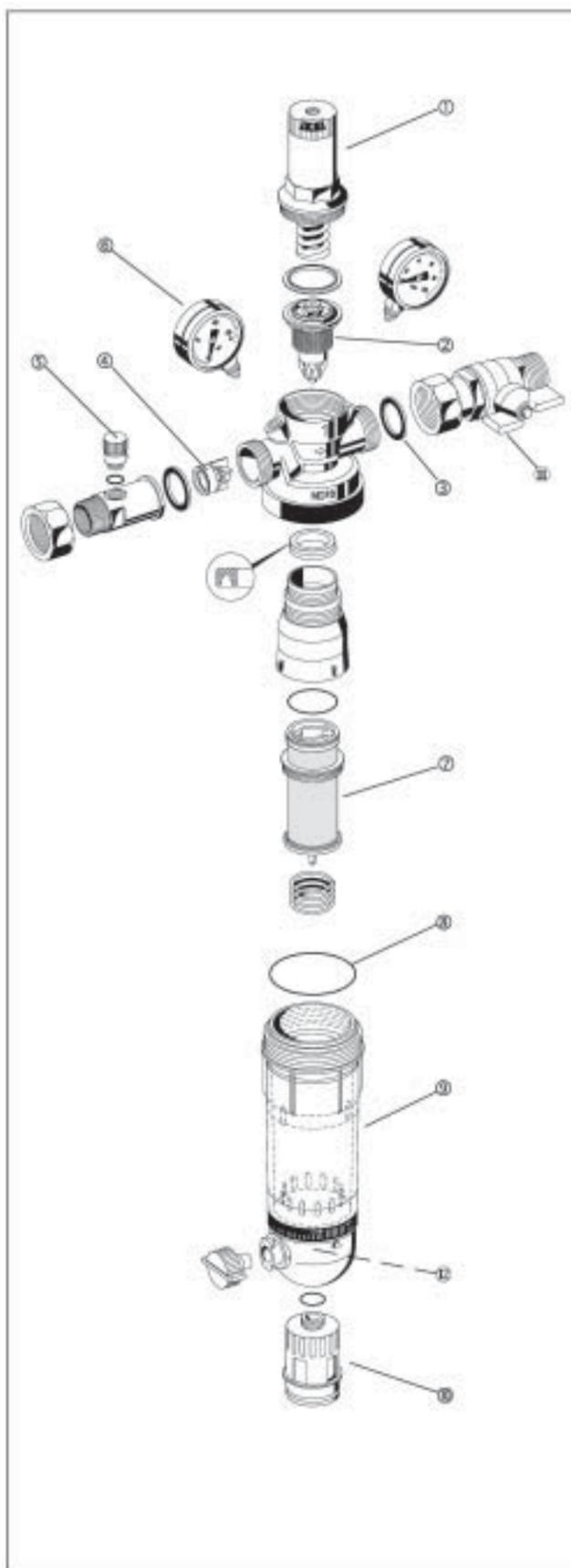
Запасные части комбинированного водоразборного узла HS 10 S (начиная с 1997 г.)
