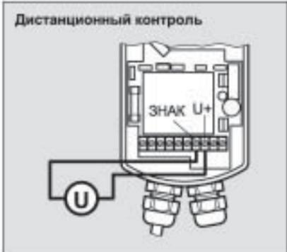
Для дистанционного контроля открытого или закрытого положения шарового клапана рекомендуется использовать центральную систему сигнализации с входным напряжением от 0 до 10 В. Максимальный допустимый ток равен 10 мА. Величина сигнала на уровне от 5 до 10 В указывает на присутствие сетевого тока и на то, что выпускной клапан закрыт.
