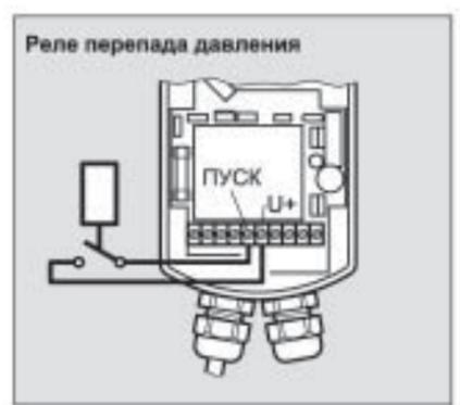
Функцией обратной промывки можно по мере необходимости управлять при помощи реле перепада давления DDS 76 с микропереключателем, имеющим "сухие" контакты. Рекомендуется устанавливать перепад давления на уровне 1,0 бар.
