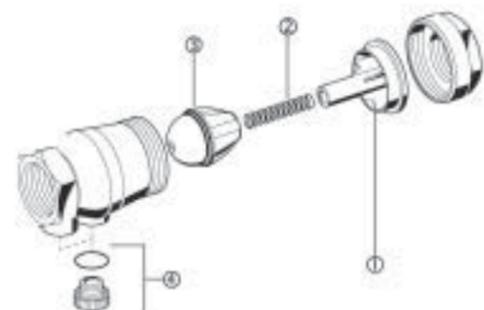
Запчасти для обратных клапанов RV 280
