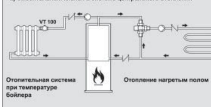
б) Распределительный клапан в системах центрального отопления
