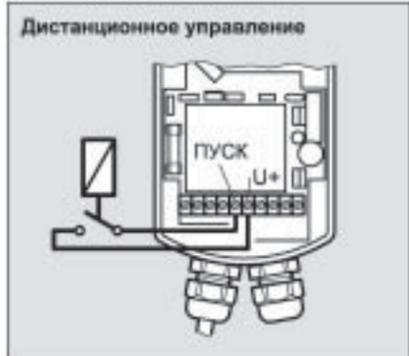
Приводом Z 11 S можно управлять дистанционно при помощи реле с переключаемыми "сухими" контактами (например, реле Honeywell Centra типа REL 2). Минимальное время удержания контактов реле для активизации обратной промывки составляет одну секунду.
