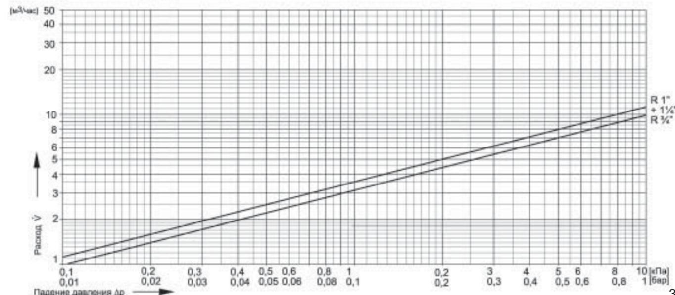
**Промываемый фильтр тонкой очистки**
