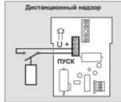
Для дистанционного надзора за открытым или закрытым положением шарового клапана рекомендуется использовать центральную систему сигнализации с входным напряжением от 0 до 10 В. Максимальный допустимый ток равен 10 мА. Величина сигнала на уровне от 5 до 10 В указывает на присутствие сетевого тока и на то, что выпускной клапан закрыт.
