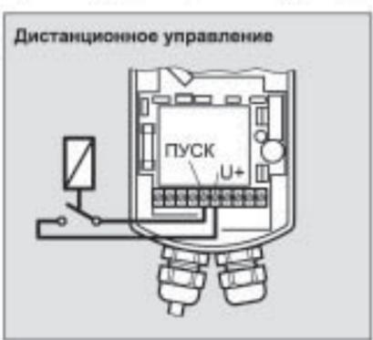
Приводом Z 11 AS можно управлять дистанционно при помощи реле с переключаемыми "сухими" контактами (например, реле Honeywell Centra типа REL 2). Минимальное время удержания контактов реле для активизации обратной промывки составляет одну секунду.
