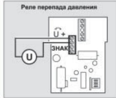
Функцией обратной промывки Z 74 A можно по мере необходимости управлять при помощи реле перепада давления с микропереключателем, имеющим "сухие" контакты (например, Honeywell FEMA, тип DDCM1). Рекомендуется устанавливать перепад давления на уровне 0,5 бар.
