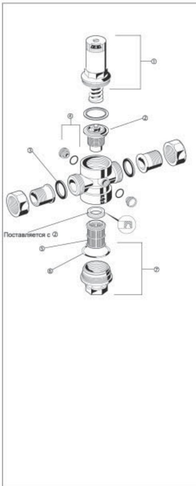
Запасные части для клапанов с понижением давления D 06 F
