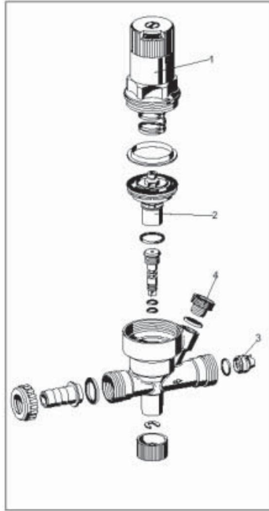
Запасные детали для наполнительных клапанов
