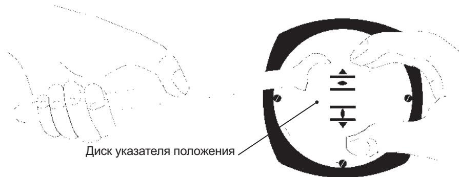
Следующее описание действительно для исполнения с «закрытием по часовой стрелке», то есть вал привода в направлении положения ЗАКРЫТО вращается по часовой стрелке.
