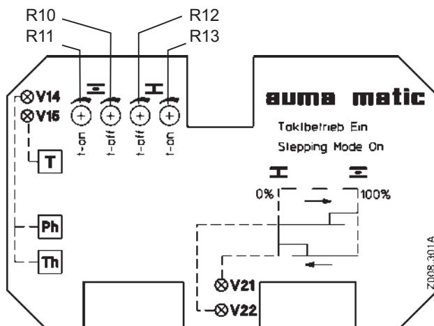
**18.2 Настройка тактового датчика**
