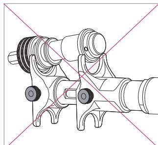
Регулярно смазывайте наконечник экспандера (тюбик со смазкой прилагается). Не смазывайте наконечник слишком обильно, чтобы смазка не попала в трубу.
