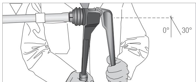
3b. Расширение с помощью расширительной насадки: Расширьте трубу один раз и повторите операцию, повернув трубу на 30°. При этом обратите внимание на минимальное расстояние (одна длина надвижной гильзы) между расширительной насадкой и надвижной гильзой.
