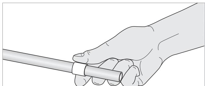
3a. Расширение с помощью экспандера: Расширьте трубу один раз и повторите операцию, повернув трубу на 30°. При этом обратите внимание на минимальное расстояние (одна длина надвижной гильзы) между расширительной насадкой и надвижной гильзой.
