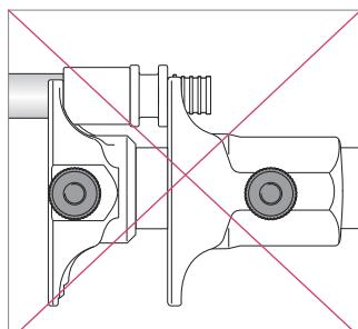
Ваш инструмент оснащен расширителем RO REHAU. Чтобы избежать повреждения трубы, не комбинируйте части расширительной системы REHAU RE (которые выпускались до 1996) с компонентами расширительной системы REHAU RO.
