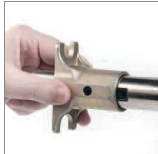
2. Полностью зафиксируйте запрессовочные тиски при помощи крепежных штифтов.
