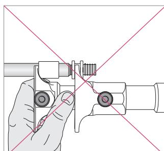
Необходимо вставлять расширительную насадку до упора в трубу!
