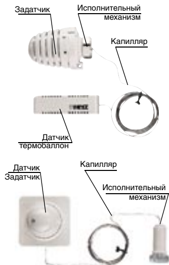
Рис.2.5. Пропорциональные регуляторы температуры прямого действия с манометрическими датчиками с жидкостным наполнителем, дистанционно разнесенные от регулирующего клапана
