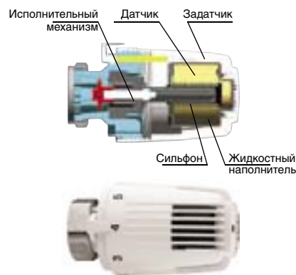
Рис.2.4. Пропорциональный регулятор температуры прямого действия с манометрическим датчиком с жидкостным наполнителем (термостатическая головка). Разрез и общий вид.
