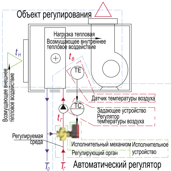
Рис. 1.6. Автоматическое регулирование температуры приточного воздуха вентиляционной системы
