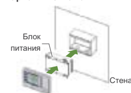
Панель управления + блок питания
