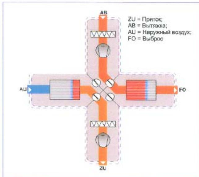
Такая установка *Resolair* особо эффективна для использования в тех помещениях, где требуется большой воздухообмен. Благодаря высокой эффективности утилизации энергии чаще всего не требуется применять отопление. Установка может быть смонтирована на крыше промышленного цеха, в результате сокращаются расходы на подводку электрокабеля и воздуховодов.
