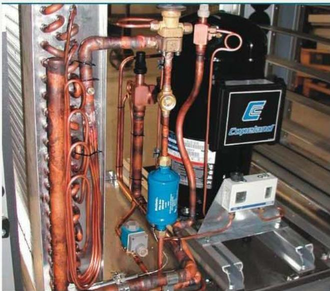
Холодильный контур теплового насоса герметичен, работает на экологически безопасном фреоне R407C.
