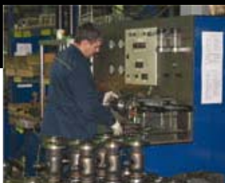
Тестирование шаровых кранов
