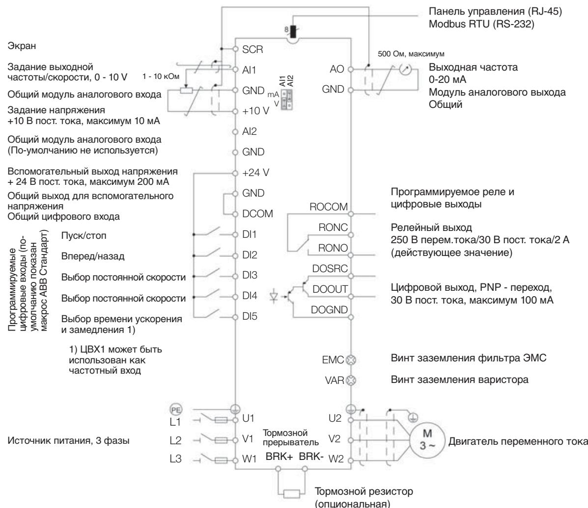
**Конфигурация ЦВХ NPN подключен (приемник)**
