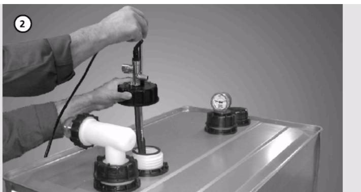
Установите DWT на ножки, а KWT пол. Часы с указателем уровня заполнения (только DWT) ввинтите в резьбовую втулку на третьем штуцере резервуара. Угловую заливную трубку с соединением для заполнения LORO-X установите на первый штуцер резервуара вместе со вставленной погружной трубкой. Смажьте уплотнительные кольца.
