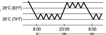
Как показано на графике справа, в течение времени, заданного для перевода назад, установленное значение термостата повышается автоматически на 2°C (4°F). Установленное значение затем возвращается к обычному значению, после того как время для перевода назад истекло.
