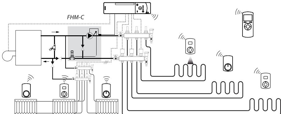
Рис. 10: Комбинированная система теплого пола с котлом
