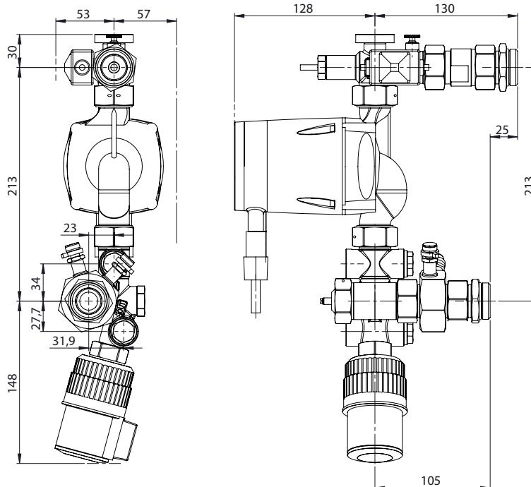
Рис. 14: FHM-C7 с приводом ABV для компенсации наружной температуры
