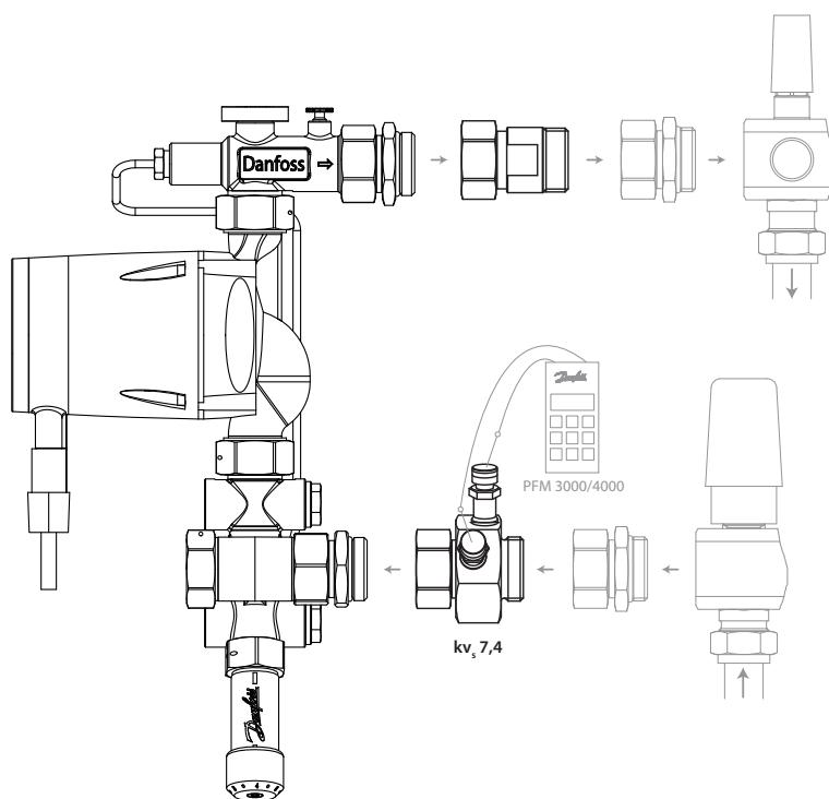
Рис. 7: Измеритель FHM-MS
