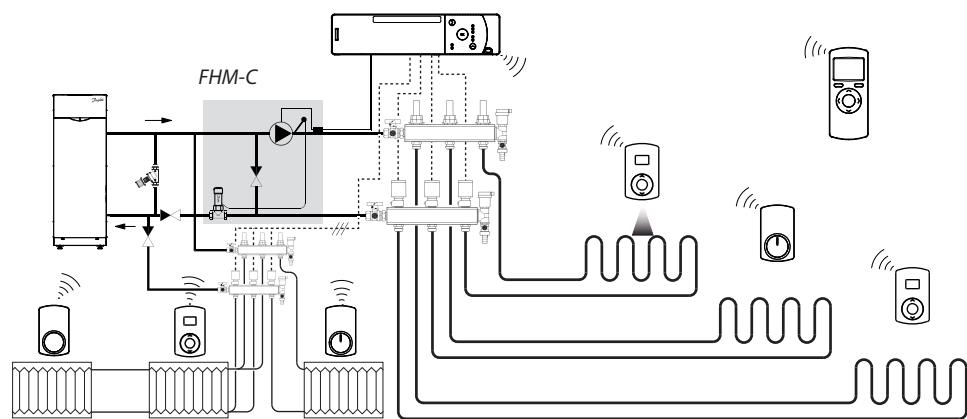
Рис. 11: Комбинированная система теплого пола с тепловым насосом
