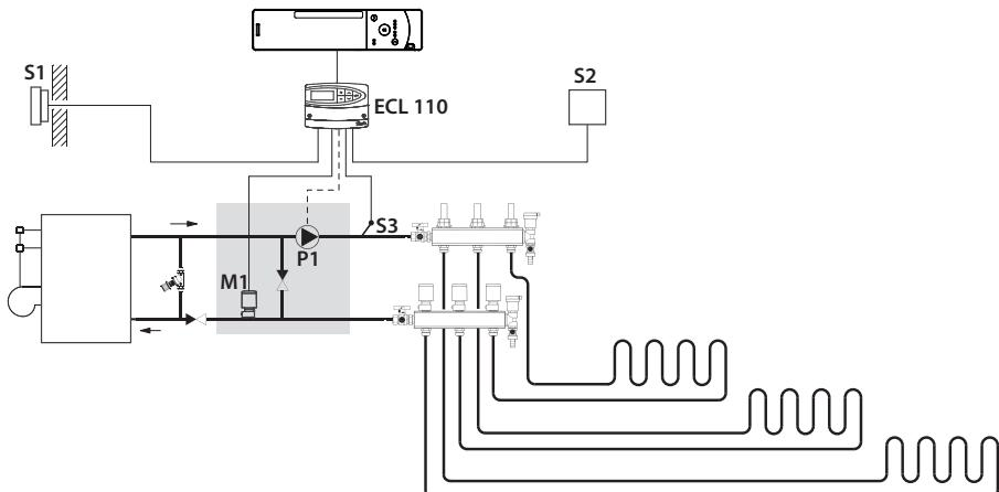
Рис. 9: Система отопления пола с ECL 110
