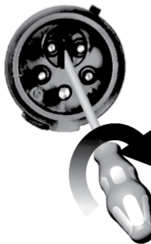
Сүр. 30 Фазалык инвертер менен үч фазалык башкаруу шкафтын фазаларын алмаштыруу
