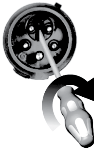
Սկար 30 Ֆազային ինվերտերով եռաֆազ կառաբարման պահարանի ֆազերի փոփոխում
