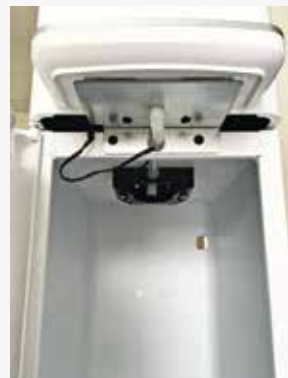
Fig. 6: Interior del armario AQA drink Pro 20 sin depósito de desagüe colgado
