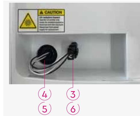
Abb. 9: Öffnung der UV-Lampe unter dem Deckel von AQA drink Pro 20
