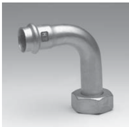
Номер по каталогу и название 18002M – отвод 90° ВПр-ВР с накидной гайкой и плоским уплотнением
